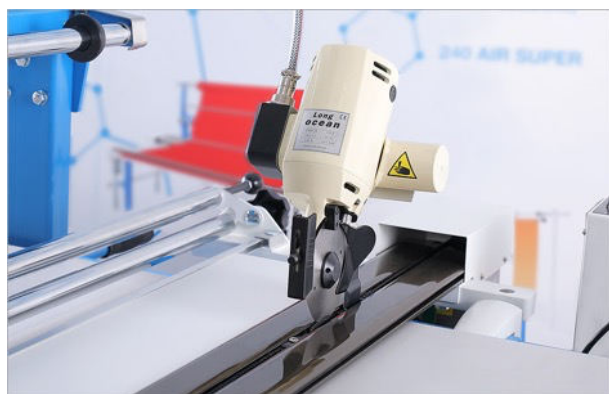
Odkrawacz automatyczny DYDB-2B w wersji Super Plus
