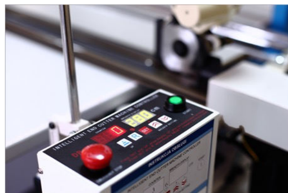
Panel sterujący odkrawacza w wersji Super i Super Plus. Licznik warstw, ustawianie długości cięcia i wysokość podnoszenia listwy.
