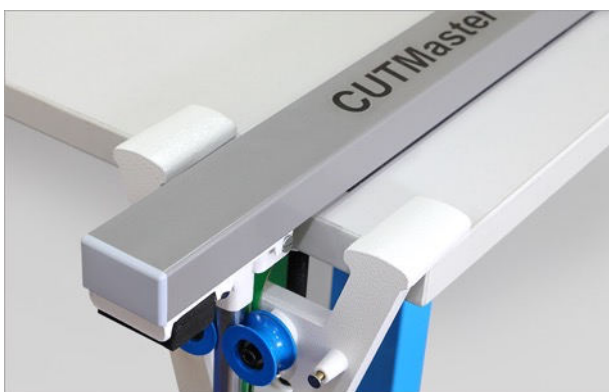
W podstawowej wersji listwa dociskowa jest podnoszona ręcznie i blokowana przy pomocy dźwigni z hamulcem mimośrodowym.
